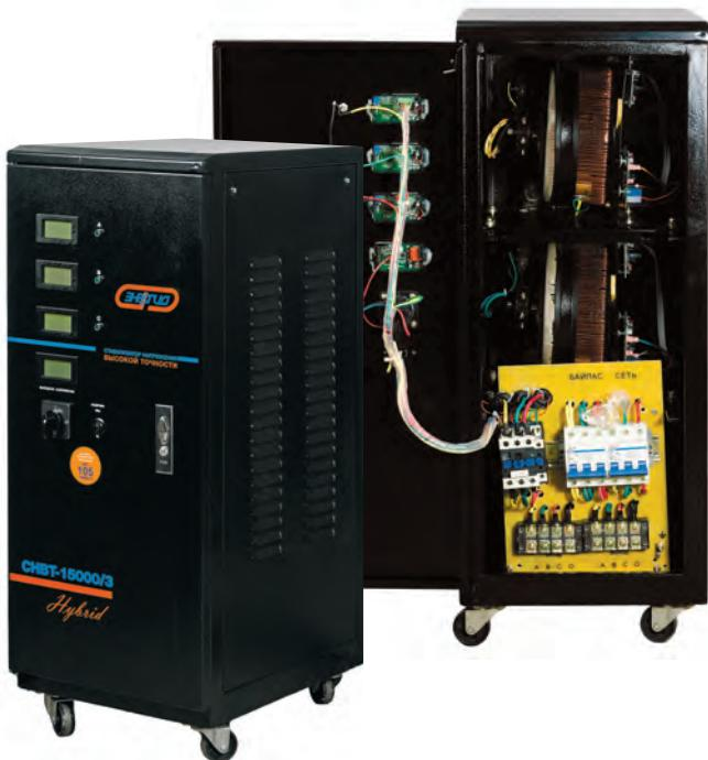
*Принцип работы — комбинированный сервоприводно/релейный — в зависимости от величины фазного напряжения сети. В диапазоне 105-144В — релейный, а в диапазоне 144-256В — сервоприводный.*
